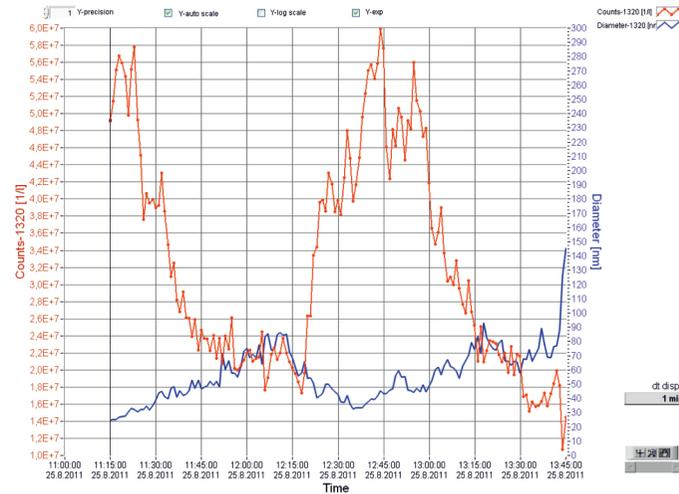
Ukázka záznamu z měření nanočástic v pracovním ovzduší pomocí systému Grimm 1.109+NanoCheck 1320 – červená křivka uvádí celkový počet všech detekovaných nanočástic v 1 cm<sup>3</sup>; modrá křivka uvádí průměrnou velikost detekovaných nanočástic [nm] během jednotlivých fází lisování plastů za tepla.
