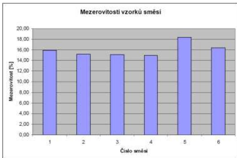
Obr. 1 Mezerovitost vzorků asfaltových recyklátů
