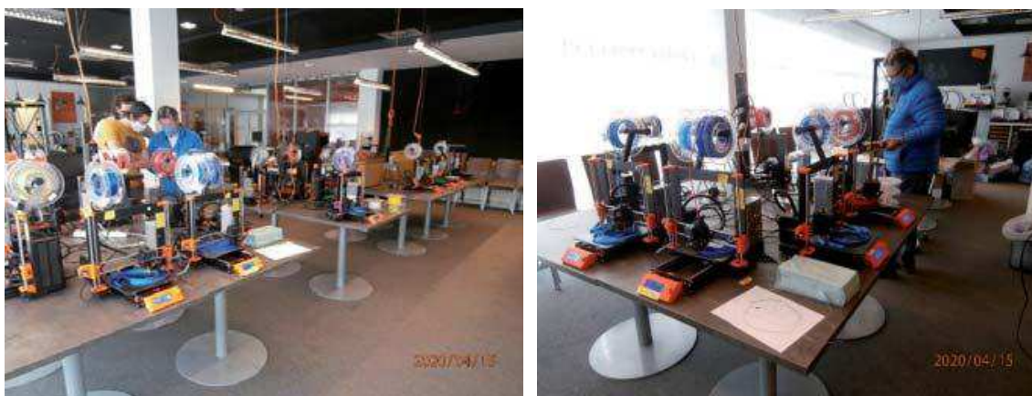
Obr. 2 Výroba komponent pro ochranné štíty na pracovišti VŠB-TUO
