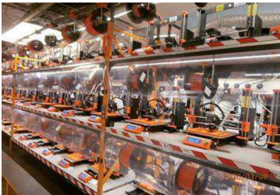
Obr. 1 Výroba dílů určených pro kompletaci 3D tiskáren pomocí 3D tisku ve společnosti Prusa Research, a.s.
