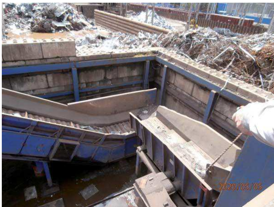
Obr. 3 Zdrobněný kovový materiál po stříhu na dopravníku
